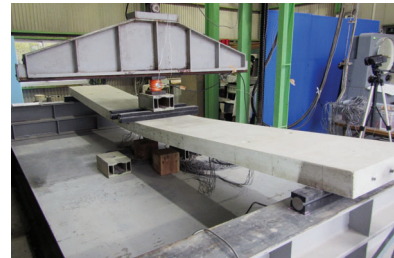
供試体による載荷試験状況
